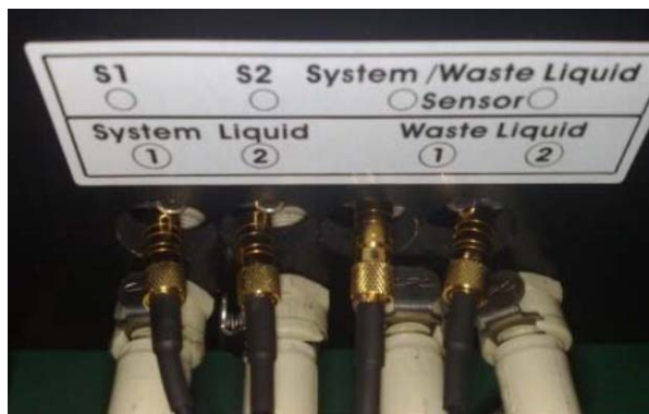
Рис. 3.2.11-1: Трубки постачання і дренажу для рідини промивання / рідини системи у правому боці аналізатора.
