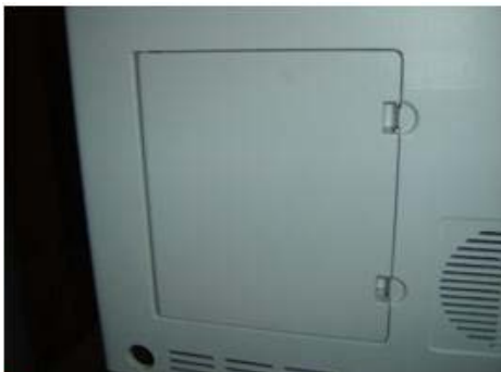
Малюнок 2-5 Зніміть задню панель аналізатора
