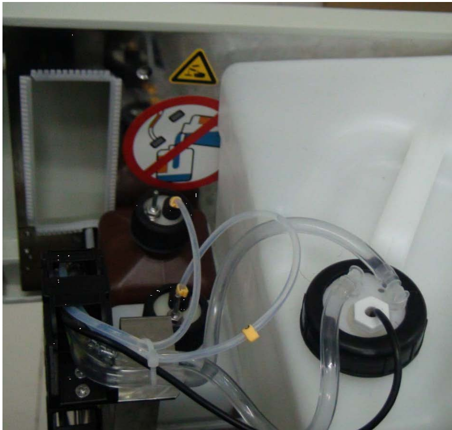
Рис 8.3-1: Етикетки, які застерігають від об'єднання реагентів, розміщені у Відсіку для стартових реагентів
