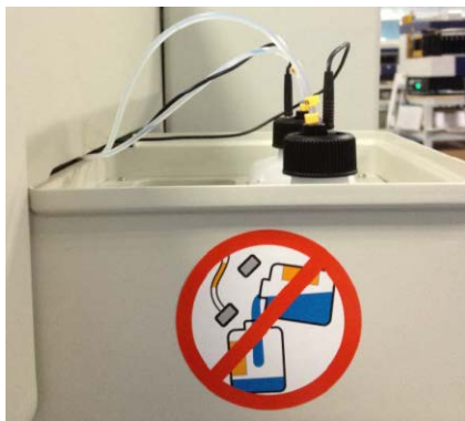
Рис. 3.2.10-1: Контейнер для стартового реактиву на правому боці аналізатора.
