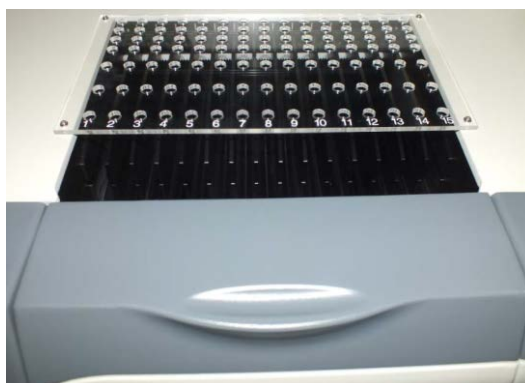
Рис. 3.2.2-2: Пристрій для реактивів із 15 доріжками для сумарних реактивів MAGLUMI 1000/2000.
