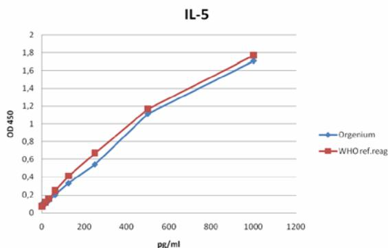
Калибровочная кривая используется, чтобы определить количество IL-5 в неизвестном образце. Калибровочная кривая производится изображением средней ОП (450 нм), полученной для каждой из концентраций стандартов на вертикальной (Y) оси против соответствующей концентрации IL-5 (пг/мл) на горизонтальной (X) оси.
